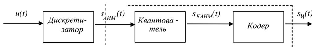
Рисунок 5.23 – Структурная схема АЦП.
